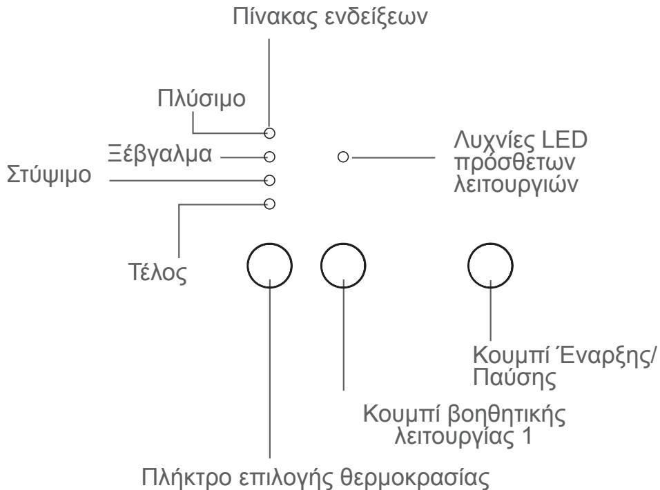
Από τις LED λειτουργιών της συσκευής μπορείτε να δείτε τη θερμοκρασία που έχετε επιλέξει, τις βιοηθητικές λειτουργίες που έχετε επιλέξει και τη φάση του προγράμματος που εκτελείται στη συσκευή σας ( φάση πρόπλυσης/ πλύσης, φάση ξεβγάλματος, φάση στυψίματος).
